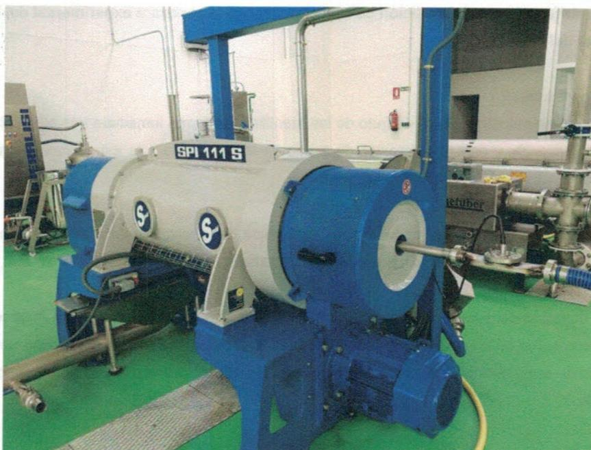
**Figura 8. Decanter Piralisi de la almazara experimental del IFAPA Centro Venta del Llano**
