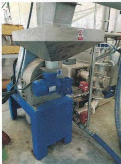
**Figura 6. Molino de martillos Perialisi de la almazara experimental del IFAPA Centro Venta del Llano**
