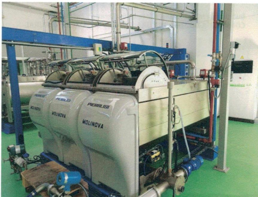
**Figura 7. Batidora de la almazara experimental del IFAPA Centro Venta del Llano**
