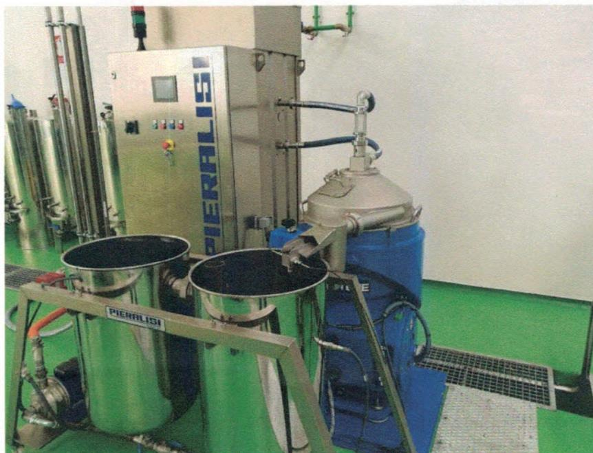
**Figura 9. Centrifuga vertical sin adición de agua Perialisi de la almazara experimental del IFAPA Centro Venta del Llano**
