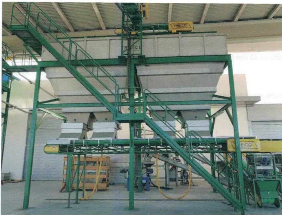
**Figura 5. Tolvas de almacenamiento de fruto divididas en dos senos de la almazara experimental del IFAPA Centro Venta del Llano**
